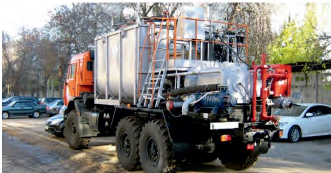
Установка представляет собой комплект оборудования, смонтированный на раме и установленный на шасси автомобильном КАМАЗ-43118.
