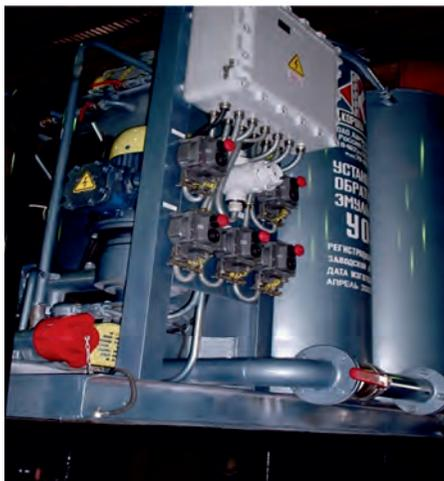
Установка приготовления обратных эмульсий УОЭ предназначена для приготовления углеводородных эмульсионно-дисперсных систем на основе реагента добычи нефти РДН, углеводородного растворителя и технической воды в соответствующих пропорциях: 20%-й раствор РДН в углеводородном растворителе 40%, техническая вода 60%.
