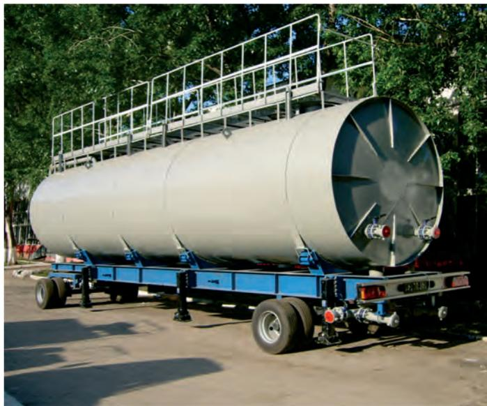
Ёмкость кислотостойкая для кислотного ГРП.
