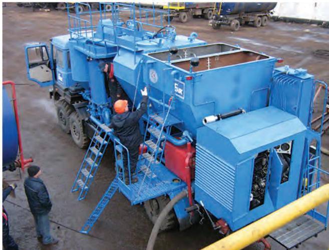
Установка насосная для ремонта скважин на базе НК-500 модели УНС-500 Д предназначена для доставки тампонирующих химреагентов и приготовления тампонажного раствора, химреагентов и материалов на основе смол при ремонте скважин. Установка применяется для проведения тампонажных работ на скважинах, обработок призабойных зон пласта и выполнения ремонтно-изоляционных работ при бурении и капитальном ремонте скважин.
