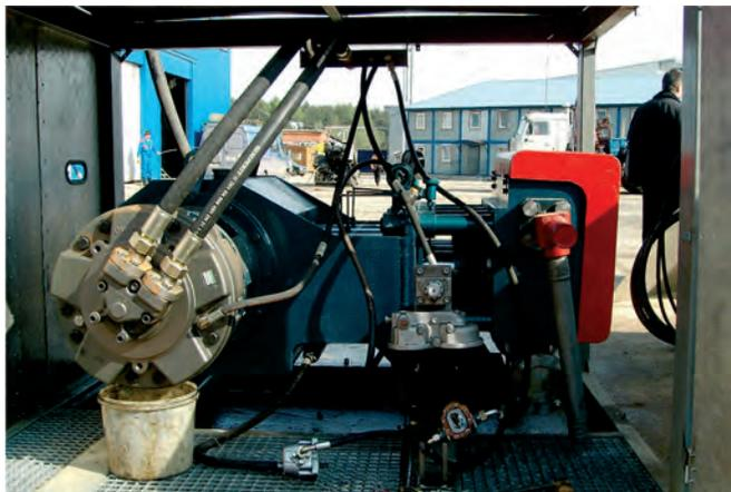
Применяемые в настоящее время в России насосы для нагнетания бурильного раствора в скважины имеют механический привод от двигателя внутреннего сгорания (ДВС) через коробку передач, при этом величина подачи меняется дискретно по мере изменения передаточного отношения привода.
