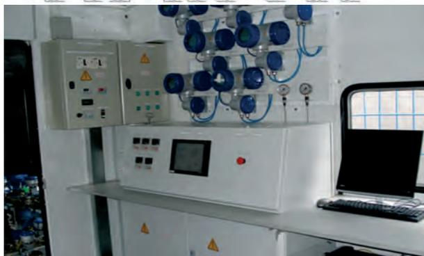
Станция управления процессом гидроразрыва пласта (ГРП) и дозирования химреагентов предназначена для: управления агрегатами выполняющих процесс ГРП, контроля и регистрации параметров, дозирования жидких химреагентов, подачи рабочего раствора к насосному агрегату
