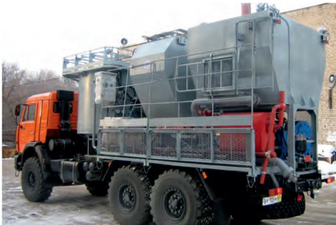
Установка насосная для ремонта скважин на базе НК-500 модели УНС-500 Ц предназначена для доставки тампонирующих химреагентов и приготовления тампонажного раствора при ремонте скважин. Установка применяется для проведения тампонажных работ на скважинах и выполнения ремонтно-изоляционных работ при бурении и капитальном ремонте скважин.
