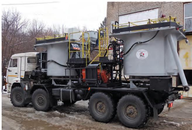
Установка насосно-смесительная УНС-32/10 предназначена для приготовления жидкостей затворения с добавками химреагентов, приготовление цементного раствора, приготовление полимерных составов и откачка составов с помощью насоса в скважину под давлением, проведение последующих промывочных работ.
