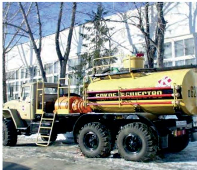
Установка насосная для кислотной обработки скважин АНК-320 предназначена для транспортировки и нагнетания кислотного раствора соляной и серной кислоты в скважину.
