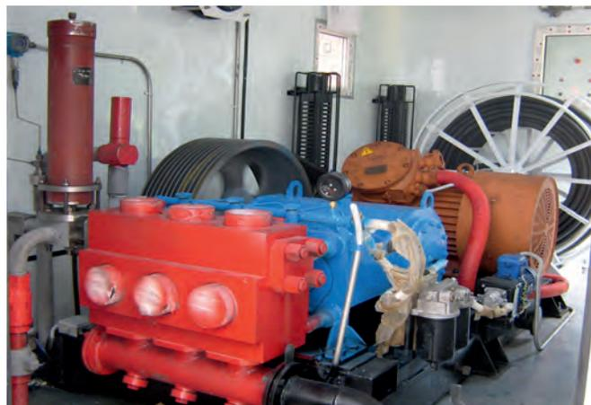
Рис. 2. Насосный блок
