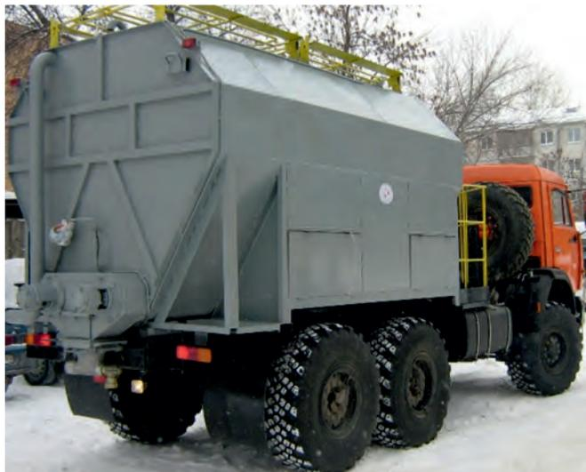
Установка предназначена для транспортирования сухих порошкообразных материалов (цемента, тампонажных смесей, глинопорошка и др.), для механически регулируемой подачи этих материалов винтовыми конвейерами (шнеками) и приготовления тампонажных растворов при проведении работ по методам ПНП и цементирования нефтяных и газовых скважин.
