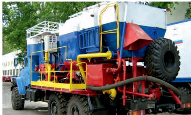
Установка насосная для ремонта скважин на базе НК-500 модели УНС-500 предназначена для доставки тампонирующих химреагентов и приготовления тампонажного раствора, химреагентов и материалов на основе смол при ремонте скважин. Установка применяется для проведения тампонажных работ на скважинах, обработок призабойных зон пласта и выполнения ремонтно-изоляционных работ при бурении и капитальном ремонте скважин.
